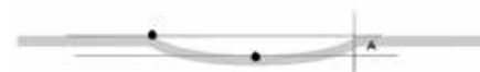
El valor de deformación sería la diferencia de altura A entre los dos puntos.
