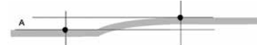
El valor de deformación sería la diferencia de altura A entre los dos puntos.
